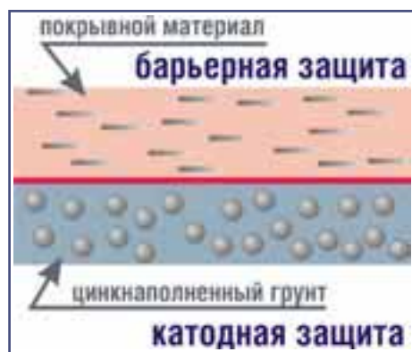
Рис.2 Схема комбинированной системы защитного покрытия на основе цинкнаполненной грунтовки и покрывной эмали.
