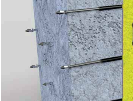
Противофильтрационная завеса на контакте грунт - конструкция
